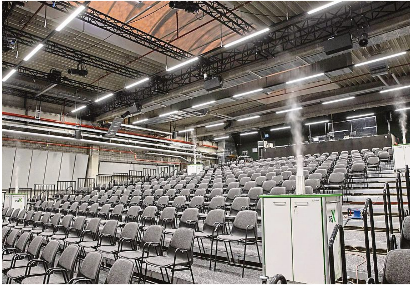
Desinfektionsmittel auf Wasserstoffperoxid-Basis wird im Theaterparkett vernebelt, ein Verfahren, das sonst in Krankenhäusern und Laboren Verwendung findet.
